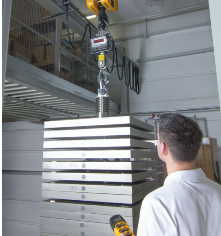
Depuis 2014, KERN utilise un dispositif de contrôle de balance à grue
